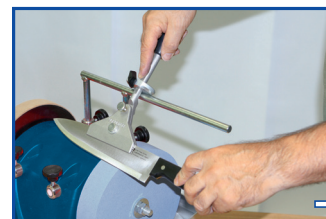
F23-120 (a richiesta) Per affilatura semplice e precisa di lame e coltelli di dimensioni da 100 mm a 200 mm.
