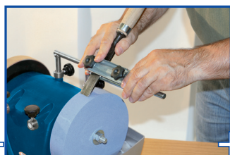
F23-070 (a richiesta) Garantisce un fissaggio preciso e sicuro per l'affilatura di diversi tipi di utensili, particolarmente indicato per scalpelli.
