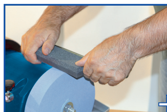
F23-010 (a richiesta) Utilizzabile su due facce: rende la grana della mola più o meno fine. Ideale per ripristinare la superficie originaria della mola.
