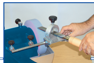
F23-055 (a richiesta) Per un appoggio ed un bloccaggio ottimale di utensili arrotondati, obliqui e concavi.
