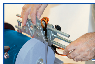
F23-160 (a richiesta) Necessario per affilare correttamente forbici per uso domestico o per usi giardinaggio / agricoltura.
