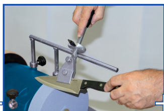
F23-060 (a richiesta) Per affilatura semplice e precisa di lame e coltelli di dimensioni da 40 mm a 100 mm.
