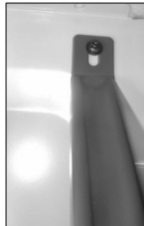
2. Utilizzate le due viti M5 x 20 mm con le rondelle per fissare i pezzi di appoggio (L) sul telaio del banco sega.
