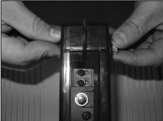
2. Togliete la protezione della lama svitando il dado di arresto a gambo quadrato. Potete anche togliere la protezione della lama dal coltello divisore.
