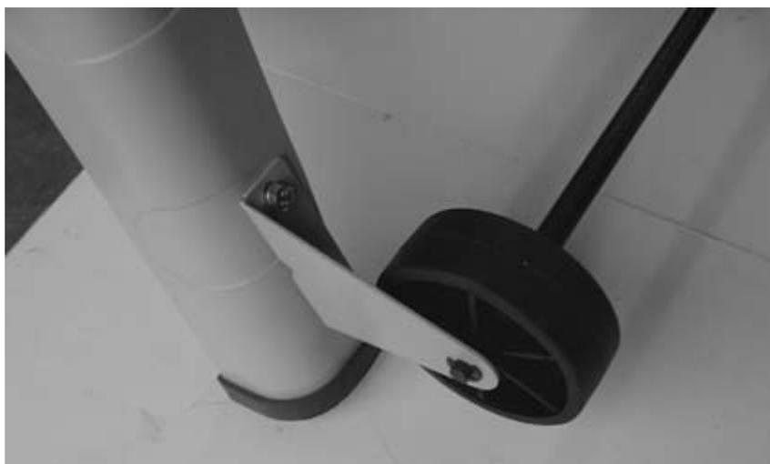
1. Fissate i supporti di bloccaggio delle ruote (O) sui montanti del basamento (H) utilizzando le viti M6x16 mm con le rondelle e i dadi.
