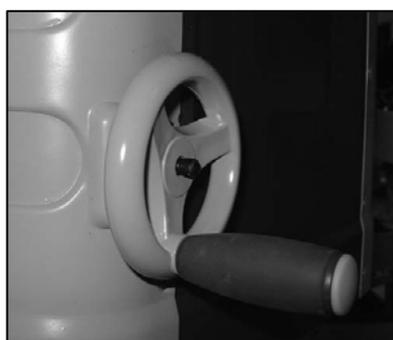
Questo volantino serve a far inclinare la lama (Fig. 21). Ruotatelo in senso orario per inclinare la lama verso sinistra. Ruotatelo in senso antiorario per riportare la lama in posizione a 90°. Assicuratevi di aver allentato il pomello situato all'altezza del volantino di salita e discesa della lama prima di inclinare la lama e assicuratevi di averlo bloccato una volta definita la posizione.
