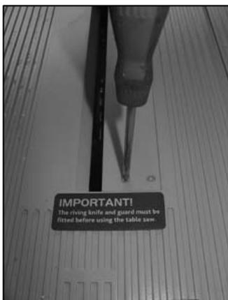
1. Svitare la vite che fissa la protezione al coltello divisore e togliete l'inserto della tavola svitando le 8 viti a testa piana Philips (Fig. 9).
