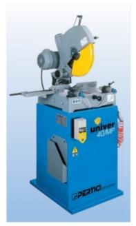
Las tronzadoras UNIVER 40 se utilizan en el sector del cerramiento, están especialmente diseñadas para el corte de perfiles de aluminio, PVC y materiales similares. La unidad de corte está dotada de una base giratoria que puede ser orientada sobre el eje vertical para llegar a un corte hasta los 45° a derecha e izquierda, también el cabezal puede ser inclinado hasta 45º respecto del eje horizontal.
