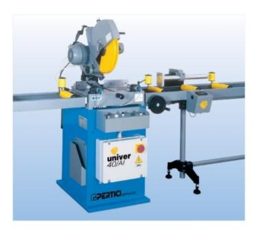
Le troncatrici monotesta Univer 40 utilizzate nel settore del serramento sono particolarmente adatte per il taglio di profilati in alluminio, P.V.C. e materiali assimilabili. L'unità di taglio è dotata di piastra girevole che può essere orientata intorno all'asse verticale per eseguire tagli fino a 45° a destra e a sinistra mentre la testa porta lama può essere inclinata a 45° rispetto all'asse orizzontale.
