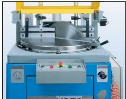
Die Gehrungssägen Univer US50 sind in erster Linie für den Schnitt von Aluminium- und PVC-Profilen ausgelegt. Den Unfallschutzvorkehrungen des Modell es wurde in mechanischer und elektrischer Hinsicht besondere Beachtung geschenkt. Beim Absenken des Sägeblatts wird der Bediener sowohl durch die obere Schutzzvorrichtung geschützt. Der Schnittwinkel ist durch die manuelle Betätigung des Drehtisches zwischen 0 und 67,5 Grad nach rechts und links einstellbar.
