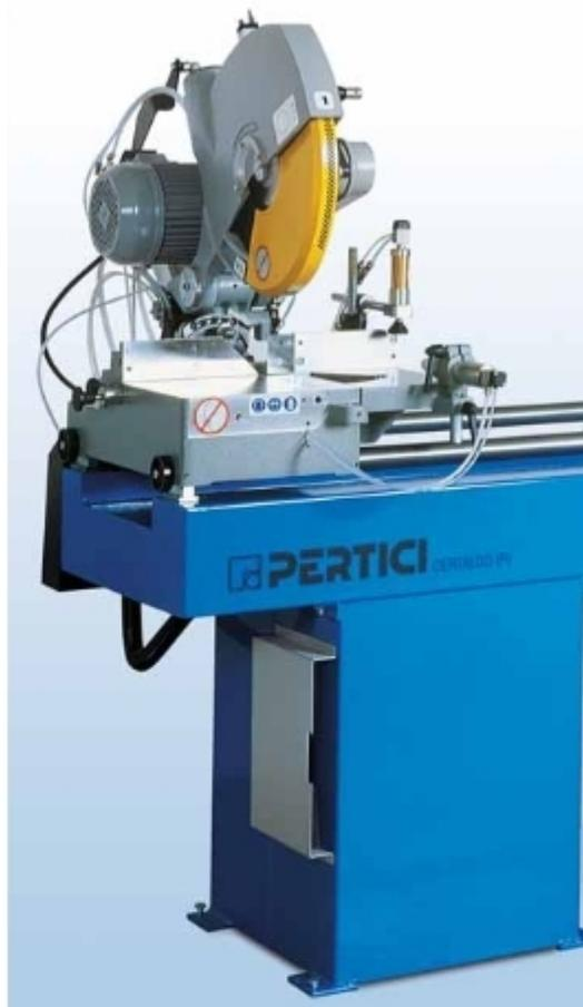
Tronçonneuse électronique à deux têtes. Positionnement automatique du chariot de la cote à l'aide de règle magnétique. Rotation manuelle des têtes coupées à 45° et intermédiaires. Inclinaison manuelle des têtes sur l'axe horizontal pour les coupes de 45° et intermédiaires. Unité de contrôle électronique programmable. Afficheur alphanumérique à 80 caractères. Clavier à effleurement protégé. Ligne série RS 232C.
