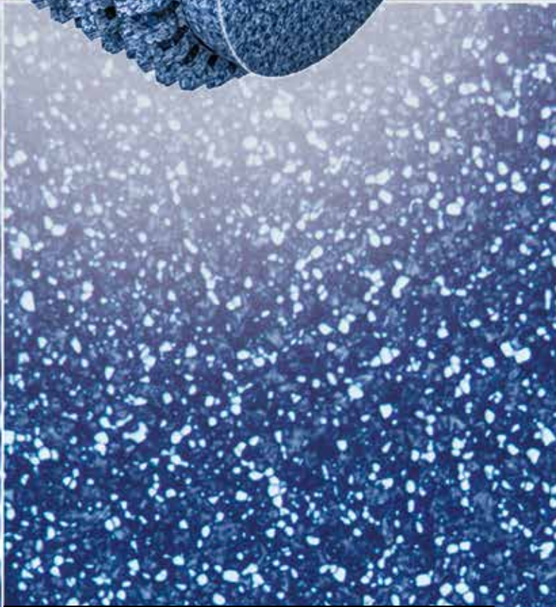
Gefügestruktur BÖHLER-S390 MICROCLEAN Image of the microstructure BÖHLER-S390 MICROCLEAN
