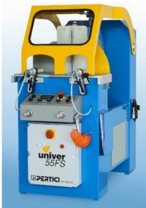
Troncatrice monotesta con lama a scomparsa per profili in alluminio, leghe leggere e PVC, doppio ribaltamento laterale pneumatico della testa, con posizioni fisse a 22,5° - 45° - 90° Sx/Dx, nonché possibilità di eseguire posizionamenti a gradi intermedi tramite regolatore e visualizzatore digitale di angoli (55/FS).
